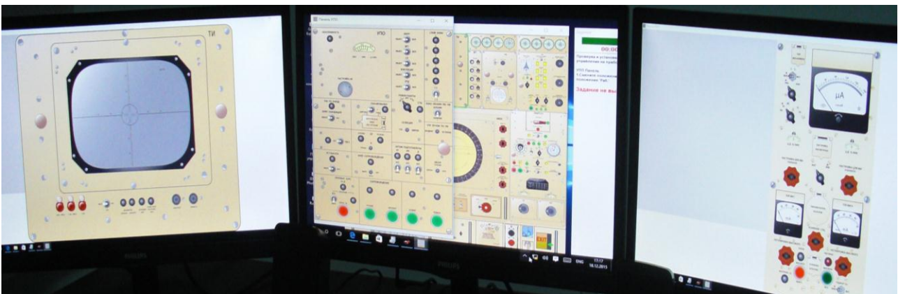
Рис. 1. Відображення на АРМ інструктора елементів системи керування вогнем корабельної артилерії.
