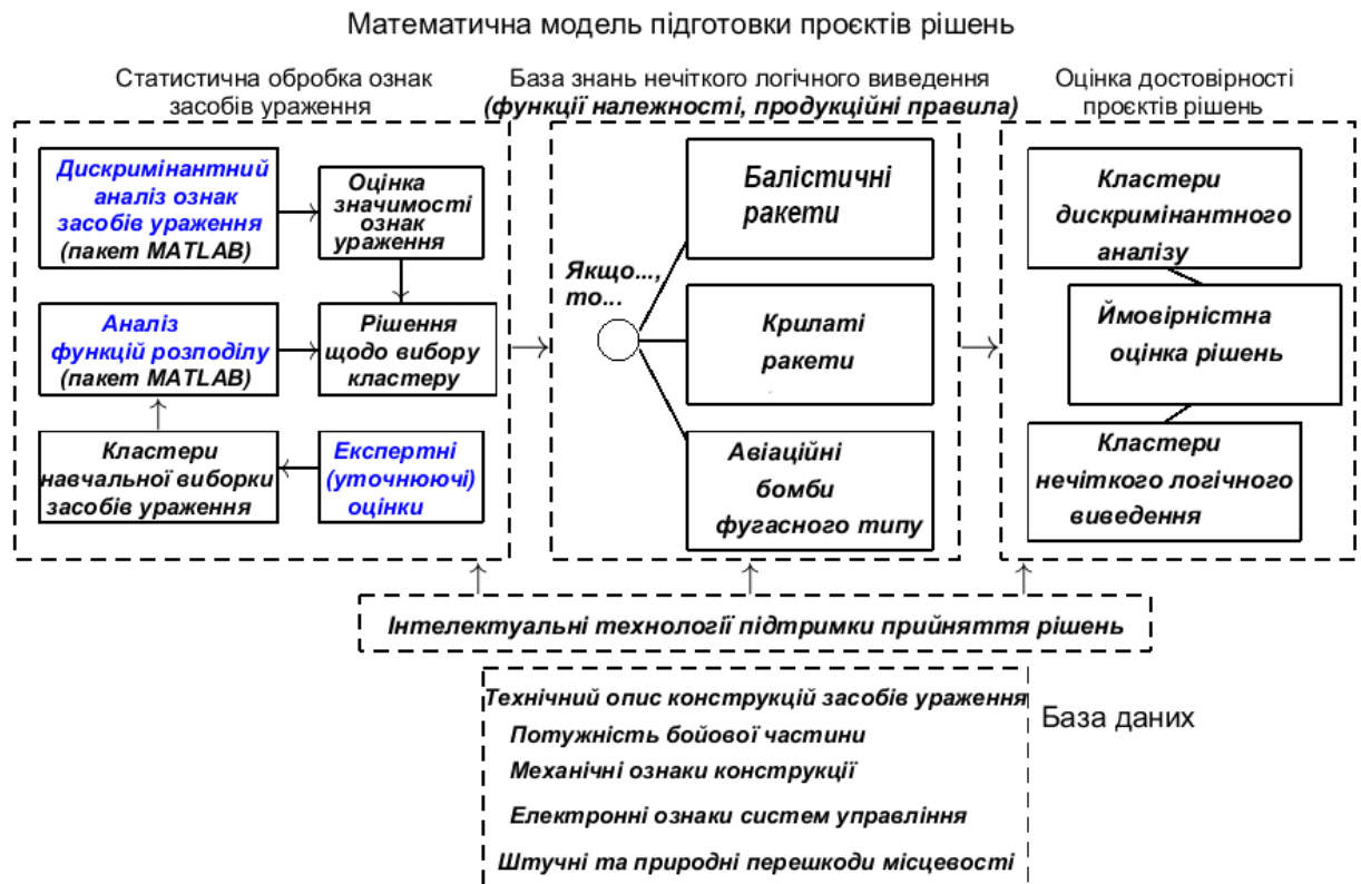
Рисунок 1 – Загальна структура математичної моделі оцінки варіантів рішень щодо розпізнавання типів засобів ураження
